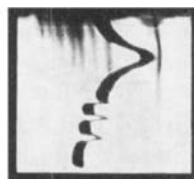
Abbild. 4. Philpot-Svensson-Aufnahme: Copolymerisat II, 124 Min. bei 50000 Touren, c = 1\%
